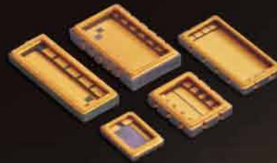
Корпуса типа LCC (безвыводные)
